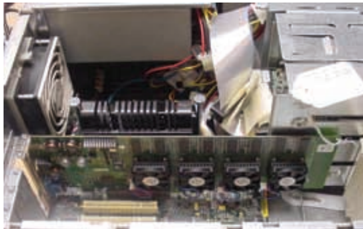
Сверху: Непосредственно выпуском видеокарты Voodoo 6000 занималась дочерняя компания 3DFX под названием Quantum 3D. Следует обратить внимание, что плата использует одновременно четыре графических процессора. Столь интересного решения в рамках текущих моделей вряд ли стоит ожидать, если учесть уровень тепловыделения.
